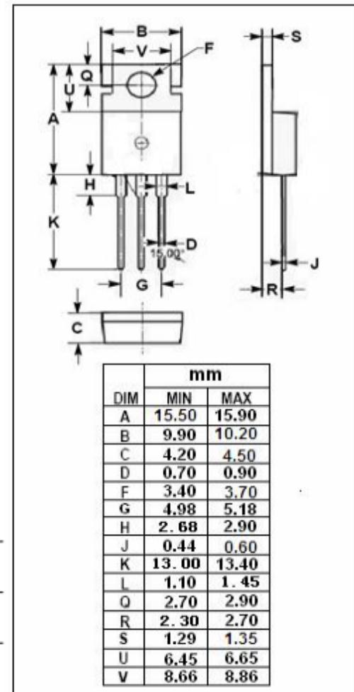
**N-Channel MOSFET Transistor****IRF2907****ELECTRICAL CHARACTERISTICS** $T_c=25^\circ\text{C}$  unless otherwise specified
